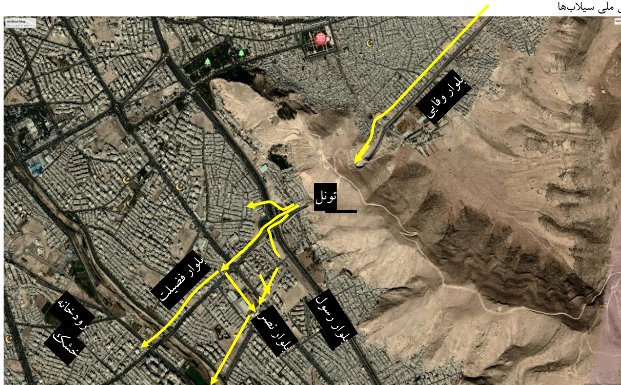
شکل ۳-۱۱ مسیر حرکت سیلاب از تونل سعدی به سمت رودخانه خشک (کارگروه مهندسی رودخانه و سازه‌های هیدرولیکی، ۱۳۹۸)
