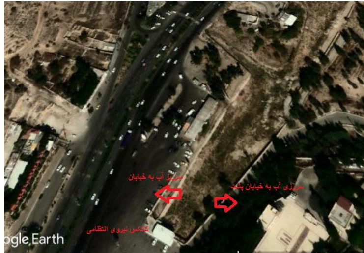
شکل ۳-۷ محل سرریز آب به خیابان از مخزن متعادل‌کننده (کارگروه مهندسی رودخانه و سازه‌های هیدرولیکی، ۱۳۹۸)
